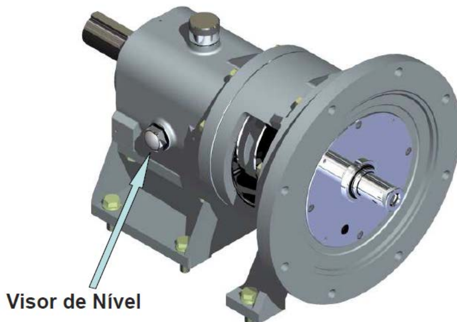
Figura 3: Ponto para verificação nível de óleo.
